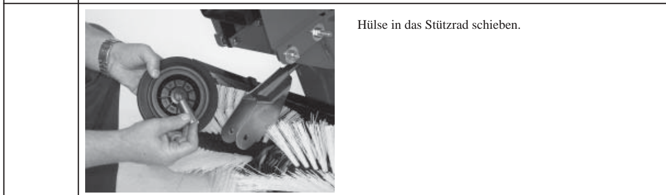
Das Stützrad in der Radgabel positionieren. Schraube mit Scheibe durch die entsprechende Bohrung der Radgabel und des Stützrades schieben.
