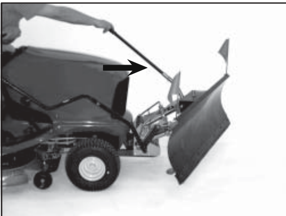
3) Heben Sie die Bedienstange an und schwenken Sie das Räumschild in die gewünschte Richtung.
