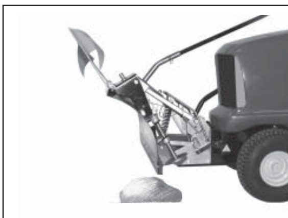
3) Zusätzlich hebt das Schild vom Boden ab.
