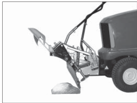
2) Räumschild-Unterkante schwenkt nach hinten. Sicherheits- Klappmechanismus ausgerastet.
