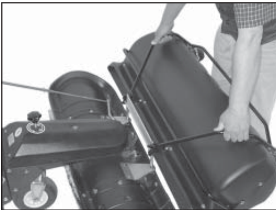
3) Kehrgutbehälter auf die Aufnahmestangen stecken und nach unten schieben.
