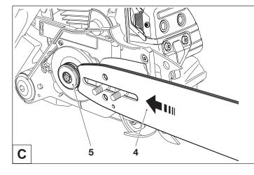
Sägeschiene (4) aufsetzen und in Pfeilrichtung gegen das Kettenrad (5) schieben.
