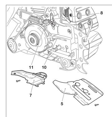
Führungsblech (5) und Abdeckung der Bremsmechanik (7) reinigen.
