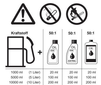
zugeben. Vor dem Einfüllen des Gemisches in die Motorsäge fertiges Gemisch gut durchschütteln.
