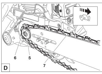
Sägekette (6) auf das Kettenrad (5) auflegen. Mit der rechten Hand die Sägekette in die obere Führungsnut (7) der Sägeschiene einführen.
