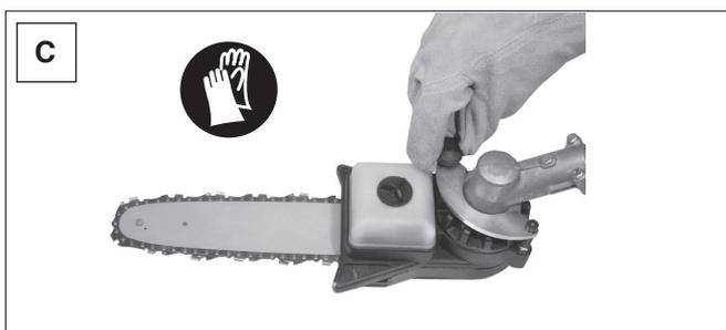
Schwenken Sie den Befestigungsbügel (A/2) über den Rand des Winkelgetriebes, bis der Befestigungsbügel in die Verriegelungsschraube (A/1) einhakt. Drehen Sie die Verriegelungsschraube fest.
