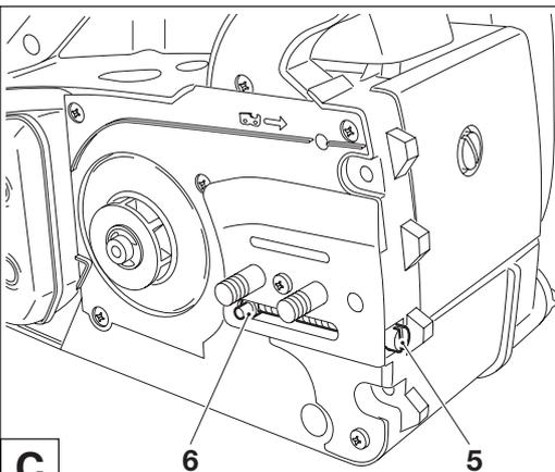
Kettenspannschraube (5) links herum (gegen den Uhrzeigersinn) drehen, bis der Zapfen (6) am linken Anschlag steht.
