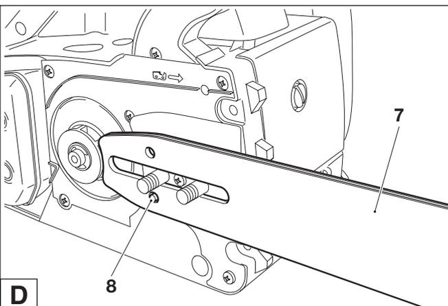
Sägeschiene (7) aufsetzen. Darauf achten, dass Zapfen (8) des Kettenspanners in das Loch der Sägeschiene eingreift.
