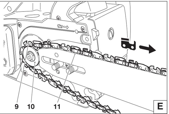
Sägekette (9) um den Umlenkstern (12) der Sägeschiene führen, dabei Sägekette leicht in Pfeilrichtung ziehen.
