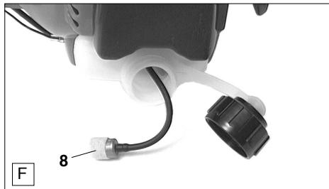
Le carburant aspiré par le carburateur est filtré par le feutre (**F8**) de la tête d'aspiration.
