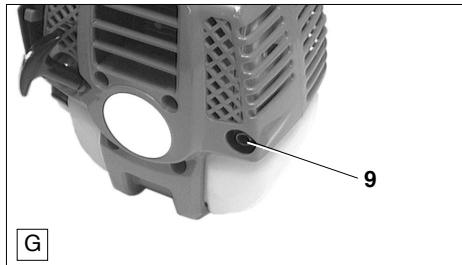
Controllare ad intervalli regolari lo sfiato del silenziatore (G/9). Se lo sfiato fosse intasato da depositi carboniosi, asportare il deposito raschiandolo con precauzione e utilizzando un utensile adatto.
