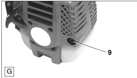
Schalldämpferöffnung (G/9) regelmäßig prüfen. Wenn die Öffnung durch Kohleablagerungen verstopt ist, Ablagerungen durch vorsichtiges Kratzen mit einem geeignetem Werkzeug entfernen.
