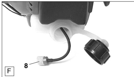
Il carburante di cui ha bisogno il carburatore viene filtrato attraverso il filtro (F/8) della testina di aspirazione.
