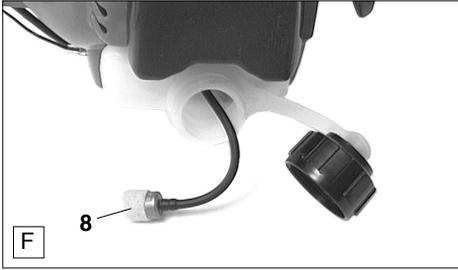
Der vom Vergaser benötigte Kraftstoff wird über den Filz (F/8) des Saugkopfes gefiltert.
