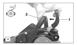
Vor jeder Montage bzw. Demontage des Kettenradschutzes (B/4), muss die Kettenbremse gelöst werden, dafür Handschutz (A/1) in Richtung Bügelgriff (A/2) ziehen, bis er fühlbar einrastet.
