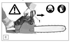
Die Prüfung der Kettenbremse muss vor jedem Arbeitsbeginn durchgeführt werden.
