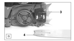
Zur einwandfreien Funktion der Ölpumpe muss die Ölführungsnut am Kurbelgehäuse (G/3), sowie die Öleintrittsbohrung (G/4) in der Sägeschiene regelmäßig gereinigt werden.
