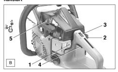
Die Vergaser dieser Motorsägen sind für den Kaltstart (Gemischanreicherung) mit einer **Chokeklappe** ausgerüstet.
