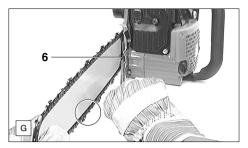
Kettenspannschraube (G/6) rechtsherum (im Uhrzeigersinn) drehen, bis Sägekette in die Führungsnut der Schienenunterseite eingreift (siehe Kreis). Dabei mit der linken Hand Sägeschiene an das Gehäuse andrücken.
