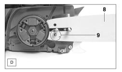
Sägeschiene (D/8) aufsetzen. Darauf achten, dass Zapfen (D/9) des Kettenspanners in das Loch (siehe Kreis) der Sägeschiene eingreift.
