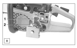
Der Schneefilter (B/1, siehe "Zubehör") verhindert das Ansaugen von Pulverschnee und wird unter den Vorfilter (B/2) gelegt.
