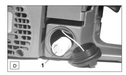
Der Filzfilter (**D/1**) des Saugkopfes kann sich im Gebrauch zusetzen. Zur Gewährleistung einwandfreier Kraftstoffzufuhr zum Vergaser sollte der Saugkopf etwa vierteljährlich erneuert werden.
