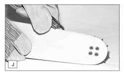
Die Laufflächen der Sägeschiene sind regelmäßig auf Beschädigungen zu überprüfen und mit geeignetem Werkzeug zu reinigen.
