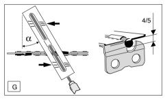
Der Feilenhalter erleichtert die Feilenführung, er besitzt Markierungen für den korrekten Schärfwinkel α (Markierungen parallel zur Sägekette ausrichten) und begrenzt die Einsinktiefe (4/5 Feilendurchmesser). Bestellnummer siehe Zubehör.
