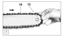
Sägekette (F/10) um den Umlenkstern (F/12) der Sägeschiene führen.
