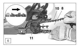
Sägekette (E/10) über die Kupplungstrommel (E/11) heben und auf das Kettenrad auflegen. Mit der rechten Hand die Sägekette in die obere Führungsnut der Sägeschiene (E/8) einführen. Die Schneidkanten der Sägekette müssen auf der Schienenoberseite in Pfeilrichtung zeigen!
