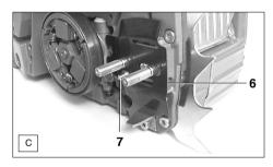
Kettenspannschraube (C/6) linksherum (gegen den Uhrzeigersinn) drehen, bis der Zapfen (C/7) am linken Anschlagsteht.
