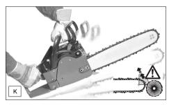
Die DOLMAR-Modelle sind serienmäßig mit einer beschleunigungsauslösenden Kettenbremse ausgerüstet. Kommt ezu einem Rückschlag (Kickback), der durch Anstoßen mit der Schienenspitze an das Holz erfolgt ist (siehe Kapitel "SICHER-HEITSHINWEISE" Seite 6), wird die Kettenbremse bei ausreichend starkem Rückschlag durch Massenträgheit ausgelöst. Im Bruchteil einer Sekunde wird die Sägekette gestoppt.
