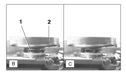
Vor dem Auflegen einer neuen Sägekette muss der Zustand des Kettenrades (B/1) überprüft werden.
