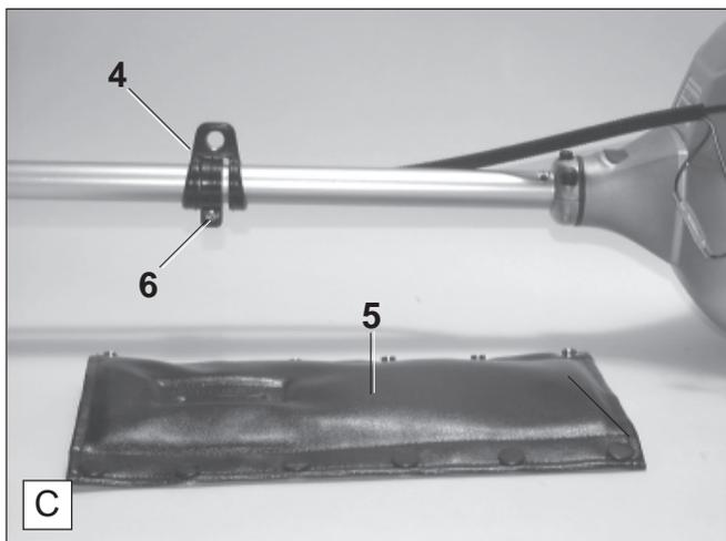
Durch Verschieben der auf dem Tragrohr befestigten Gurthalterung (C/4), kann die Balance der Motorsense verändert werden.
