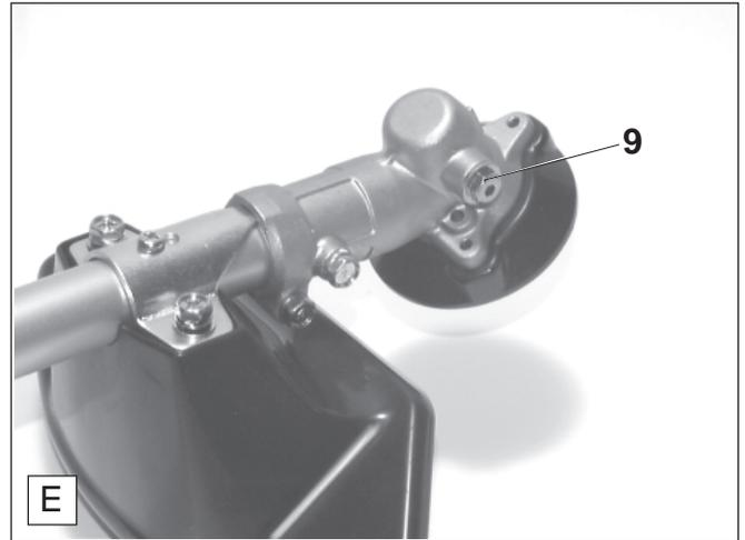
Nach ca. 50 Betriebsstunden sollte das Winkelgetriebe (E/9) von einer DOLMAR Fachwerkstatt überprüft und ggf. Fett nachgefüllt werden. Die Fettfüllung wird von der Fachwerkstatt genau dosiert, da zu große Fettmengen zu Überhitzungen im Winkelgetriebe führen.
