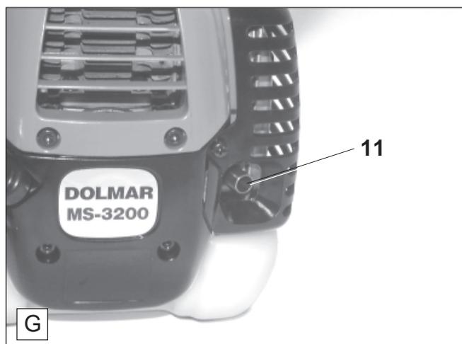
Schalldämpferöffnung (G/11) regelmäßig prüfen. Wenn die Öffnung durch Kohleablagerungen verstopft ist, Ablagerungen durch vorsichtiges Kratzen mit einem geeignetem Werkzeug entfernen.
