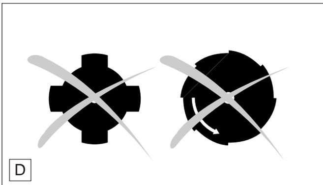
**ACHTUNG:** Die nachfolgend aufgeführten Schneidwerkzeuge dürfen **nur** von einer Fachwerkstatt nachgeschärft werden, da ein Nachschärfen von Hand zu Unwucht am Schneidwerkzeug, zu Vibrationen und Schäden am Gerät führen kann.
