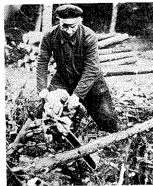
Entästen und Ablängen am Zopf alles mit der Type CF
