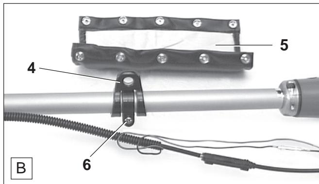
Durch Verschieben der auf dem Tragrohr befestigten Gurthalterung (B/4), kann die Balance der Motorsense verändert werden.
