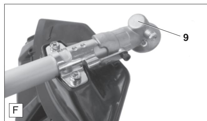
Dopo circa 50 ore di esercizio, far controllare il meccanismo a scatola conica (**F/9**) da un'officina autorizzata DOLMAR, per aggiungere, se necessario, il grasso lubrificante. La dose di lubrificante utilizzata dall'officina sarà regolata in modo da evitare che una dose eccessiva di lubrificante causi un surriscaldamento del meccanismo a scatola conica.
