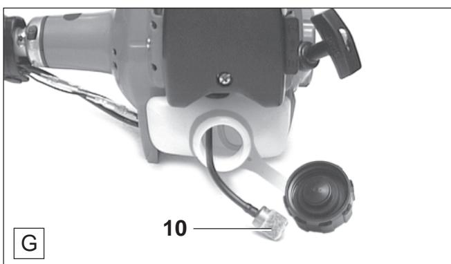
Der vom Vergaser benötigte Kraftstoff wird über den Filz (**G/10**) des Saugkopfes gefiltert.
