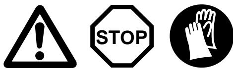
Durante le operazioni sull'utensile da taglio, sul meccanismo a scatola conica o sulla calotta di protezione (sostituzione o pulizia) indossare assolutamente i guanti protettivi, spegnere il motore ed estrarre lo spinotto della candela!
