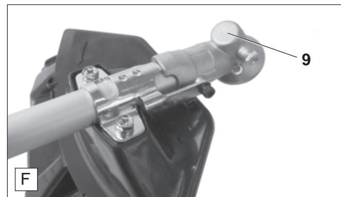
Nach ca. 50 Betriebsstunden sollte das Winkelgetriebe (**F/9**) von einer DOLMAR Fachwerkstatt überprüft und ggf. Fett nachgefüllt werden. Die Fettfüllung wird von der Fachwerkstatt genau dosiert, da zu große Fettmengen zu Überhitzungen im Winkelgetriebe führen.
