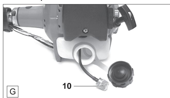
Il carburante di cui ha bisogno il carburatore viene filtrato attraverso il filtro (**G/10**) della testina di aspirazione.
