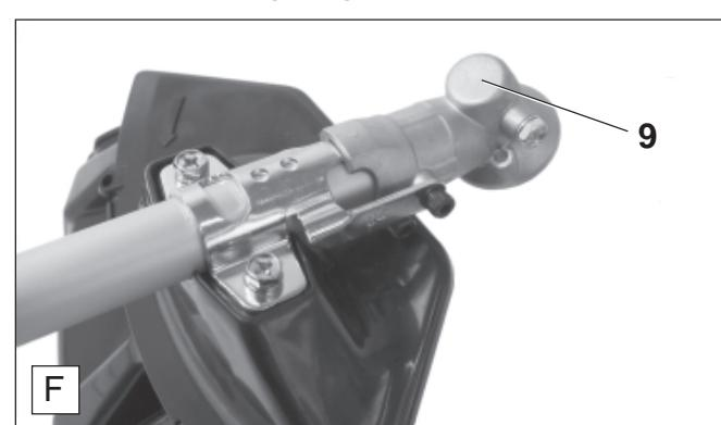
Après environ 50 heures de service, il est recommandé de faire vérifier l'engrenage conique (**F/9**) par un atelier spécialisé DOLMAR et d'ajouter de la graisse si nécessaire. Le dosage de graisse exact est effectué par l'atelier spécialisé, étant donné que de trop grandes quantités de graisse entraînent des surchauffes dans l'engrenage conique.
