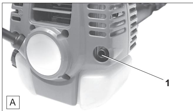
Controllare ad intervalli regolari lo sfiato del silenziatore (**A/1**). Se lo sfiato fosse intasato da depositi carboniosi, asportare il deposito raschiandolo con precauzione e utilizzando un utensile adatto.
