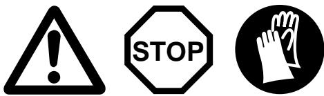
Bei allen Arbeiten am Schneidwerkzeug, am Winkelgetriebe oder an der Schutzhülle (Werkzeugwechsel oder Reinigung) unbedingt Schutzhandschuhe tragen, Motor ausschalten und Kerzenstecker ziehen!
