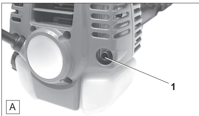
Schalldämpferöffnung (**A/1**) regelmäßig prüfen. Wenn die Öffnung durch Kohleablagerungen verstopft ist, Ablagerungen durch vorsichtiges Kratzen mit einem geeignetem Werkzeug entfernen.
