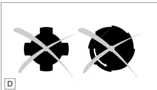
**Attention:** Les outils de coupe suivants ne doivent être affûtés que par un atelier spécialisé car un affûtage à la main pourrait produire un balours, et par là, des vibrations et endommagement de l'appareil.
