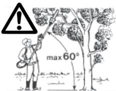
Halten Sie die Motorsense nie steiler als in einem Winkel von 60° zu der Erdoberfläche!
