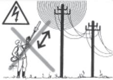
Niemals in der Nähe von elektrischen Leitungen arbeiten. Der Mindestabstand zu einer Hochspannungsleitung beträgt 10 Meter. In einer geringeren Entfernung darf der Hochentaster unter keinen Umständen betrieben werden.
