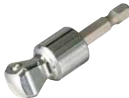
E-03436 Torsion Adapter 1/4" 6-kant zu 1/2" 4-kant für den Einsatz in Schlagschraubern. Das Gelenk erlaubt eine Neigung von 15° und eignet sich so für Arbeiten auf engstem Raum.
