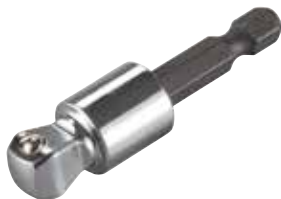
E-03420 Torsion Adapter 1/4" 6-kant zu 3/8" 4-kant für den Einsatz in Schlagschraubern. Das Gelenk erlaubt eine Neigung von 15° und eignet sich so für Arbeiten auf engstem Raum.
